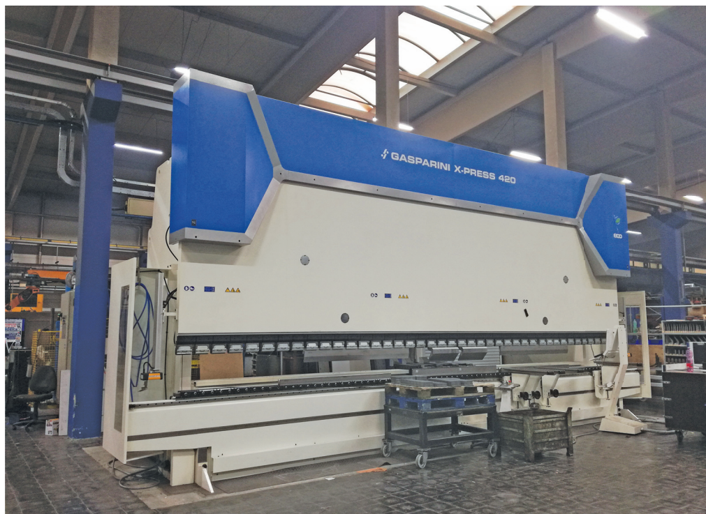
V loňském roce mezi nové technologické vybavení přibyl ohraňovací lis na ohýbání plechů v délce až osm metrů.
