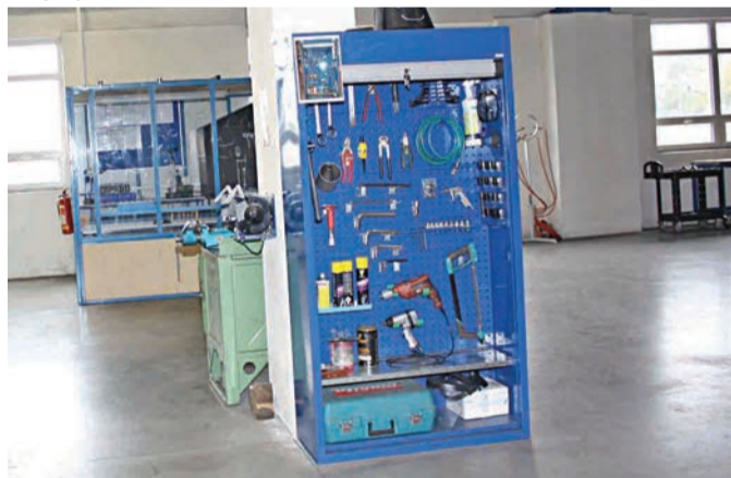
Uspořádání nástrojů v souladu se systémem 5S.
